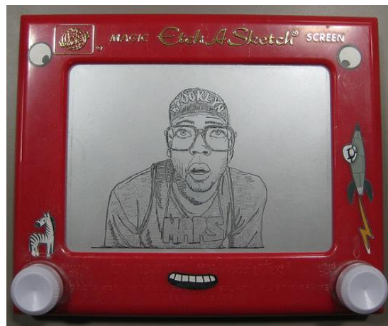
Figure 3. Exemple de courbes réalisées avec une ardoise magique qui n'autorise que deux mouvements de translation pour déplacer le crayon (photo Games and Geeks).
