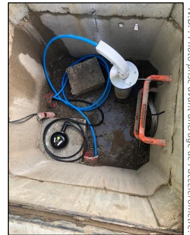
▲ Figure 2. Gauche : forage en cours à NIMR (photo Cerema, février 2017). Droite : le regard du capteur à 10 m avec la tête de forage d'où sort le câble du capteur Radian (photo M. Pernoud, Cerema, 9 octobre 2020).
