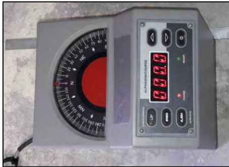
▲ Figure 6. Gauche : coffret équipé pour le moment de 2 batteries. Milieu : Gyrocompas aligné au Nord avec une règle métallique servant au traçage de la direction. Droite : capteur Episensor FBA-EST Kinematics installé sous sa bride d'ancrage, après traçage et matérialisation de l'encombrement du futur capot isolant.
