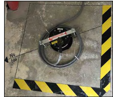
▲ Figure 6. Gauche : coffret équipé pour le moment de 2 batteries. Milieu : Gyrocompas aligné au Nord avec une règle métallique servant au traçage de la direction. Droite : capteur Episensor FBA-EST Kinematics installé sous sa bride d'ancrage, après traçage et matérialisation de l'encombrement du futur capot isolant.
